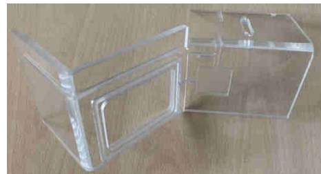
Parte meccanica realizzata in plexiglas che consente l'ingresso dei roditori all'interno al contenitore attraverso un passaggio regolato da uno sportellino basculante. La porta è leggermente sollevata dal livello del pavimento per evitare che il possibile ingresso di lucertole o insetti possa attivare il sistema.
